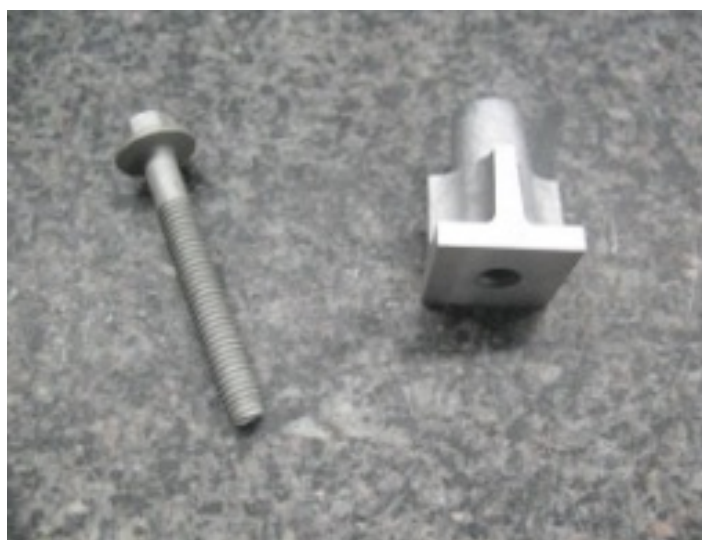
図 7.6 スレッドフォーミングファスナーと鋳造ナット
