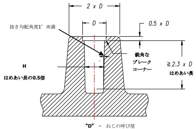
プラスチック用の推奨下穴径は、右欄の指標にねじの呼び径を掛けて導き出されます。この結果得られる推奨下穴径は、アプリケーションの締付け仕様を決定する為の試験に於いて、下穴径の初期設定値として使用されます。
