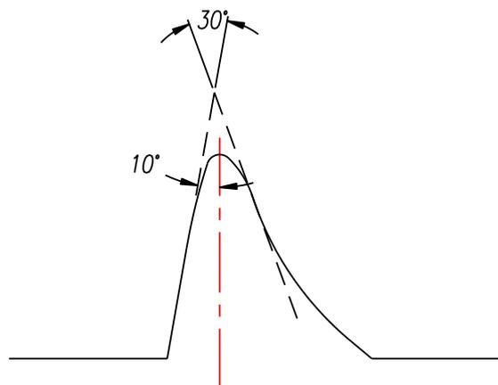
REMFORM® II™ “HS”の左右非対称な Unique Radius Flank™のねじ山形状は、30°の左右対称ねじ山の製造上の難しさを排除し、しかもめねじのねじ山転造時に於ける半径方向応力を減少させるという長所を持っています。
